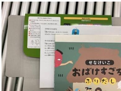
丁合・セット作業・・・指定された順番に丁合を行い、封入・セットなどの作業を行います。写真の物は厚紙・折り返してある印刷物なので、「手丁合」をします。その他ペラものであれば、機械丁合も受付ます。
