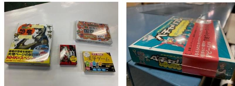
シュリンク作業・・・現在主な作業としては、「カードゲーム」のシュリンク包装を行っています。大きささまざまな大きさの製品をシュリンク機に通して、穴あき・ヨレがないかの検品を行い、完包・段ボール梱包を行います。
